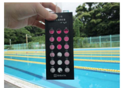
遊離残留塩素を測定しています。試薬に反応した赤色の濃淡によって濃度値を判定します。
