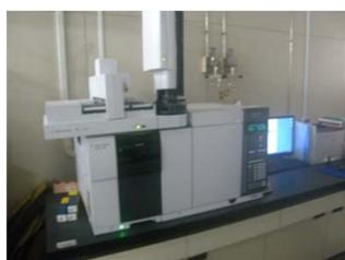
測定機器(写真はガスクロマトグラフ質量分析装置)
